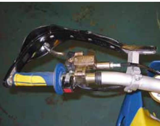
Rätt typ av handtagsskydd tillsammans med röda "dödarknappen" lätt åtkomlig. ↑
