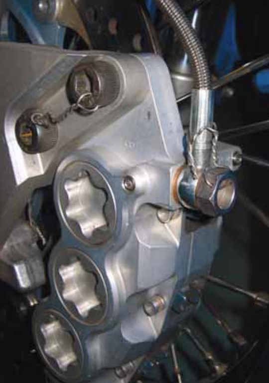
Najtråd genom "banjobulten". Tråden fästs sedan t.ex. runt bromsslängen ↑
