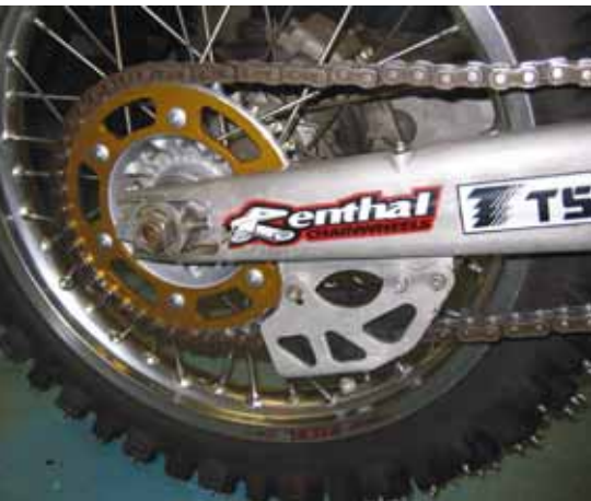
Bakre kedjeskydd som sitter på de flesta maskiner original och som är ett måste. ↑
