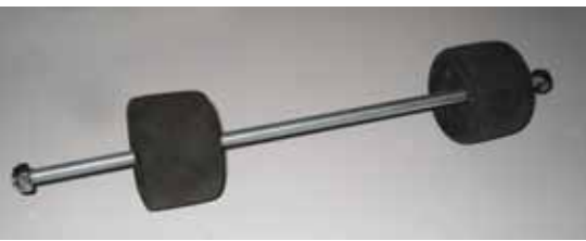
En enkel doning för att skydda hjulaxelmuttern. ↑
